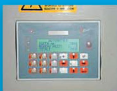
PLC di programmazione tagli e misure (opzionale ai contametri standard)
