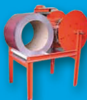
Svolgitore da Coils con contametri
